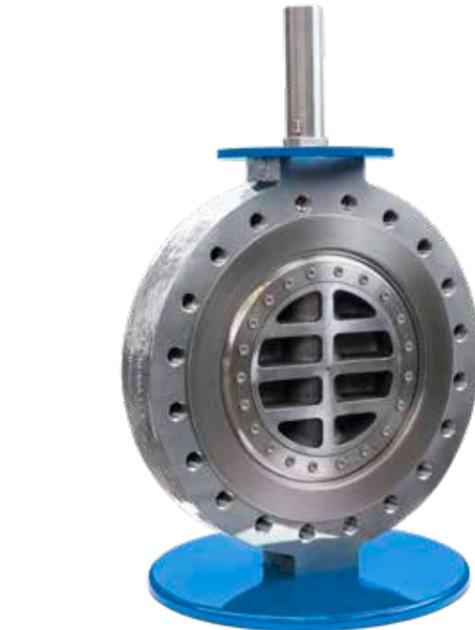
Bei der Sitzgeometrie der 5-fach exzentrischen V-AXX® schneiden sich die Linien der 3D Figur nicht in einem Punkt, sondern können völlig unabhängig voneinander an jeder Stelle des Sitzes nach Konstrukteurvorgabe angeordnet werden. Dies ermöglicht es sogar, eine Klappe zu konstruieren, deren Wellenmitte in der Rohrleitungsmitte liegt und trotzdem reibungsfrei öffnet.
