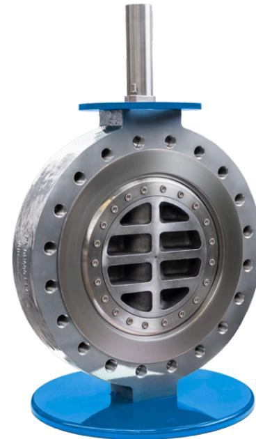
Bei der Sitzgeometrie der 5-fach exzentrischen V-AXX® schneiden sich die Linien der 3D Figur nicht in einem Punkt, sondern können völlig unabhängig voneinander an jeder Stelle des Sitzes nach Konstrukteurvorgabe angeordnet werden. Dies ermöglicht es sogar, eine Klappe zu konstruieren, deren Wellenmitte in der Rohrleitungsmitte liegt und trotzdem reibungsfrei öffnet.
