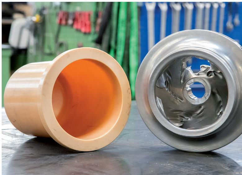
Abb. 7: Völlig verschlissenes Pumpenlaufrad nach schwerer Sandbelastung mit unbeschädigtem Keramikspalttopf
