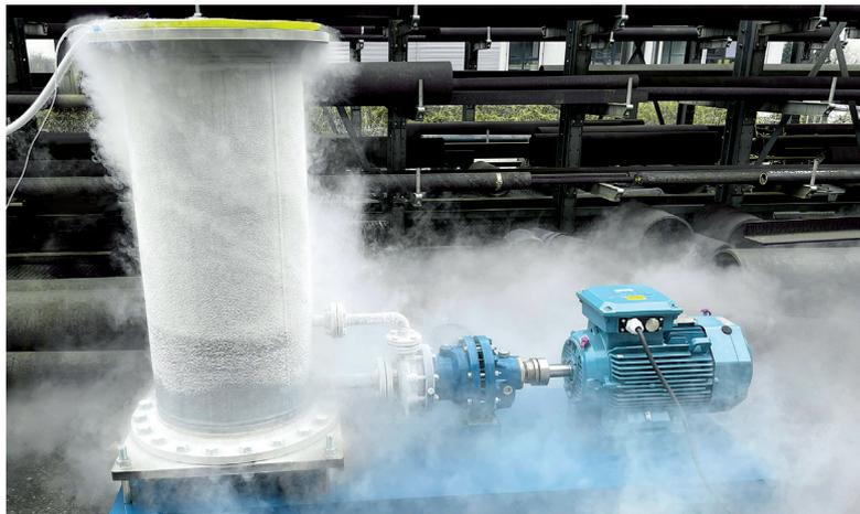
Abb. 6: Pumpe zur Förderung von Flüssigstickstoff bei einem Test für neue Lager
